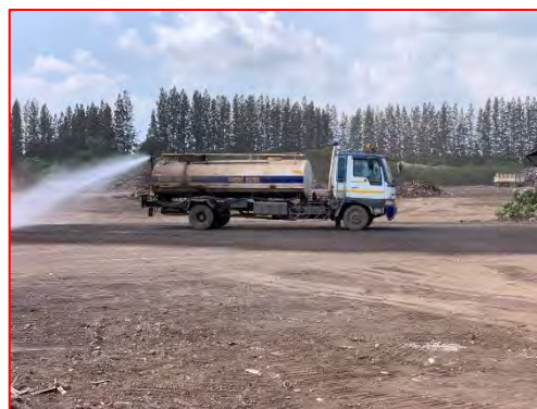
ภาพที่ 2.2-8 การนำน้ำทิ้งจากอาคารสำนักงาน ที่ผ่านการบำบัดแล้วกลับไปใช้ประโยชน์ โดยการฉีดพรมน้ำบริเวณถนนในโรงงาน
